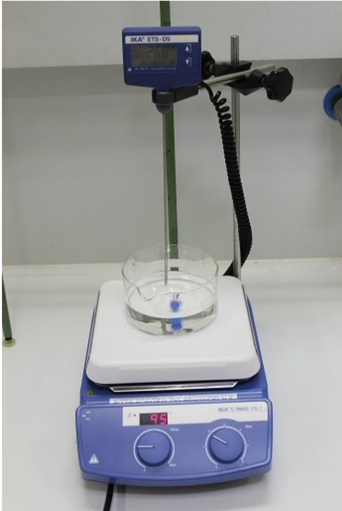
Abbildung 3: Magnetrührer mit Heizfunktion mit Thermometer (26.8° C), Glasschale mit Wasser und Rührfisch.
