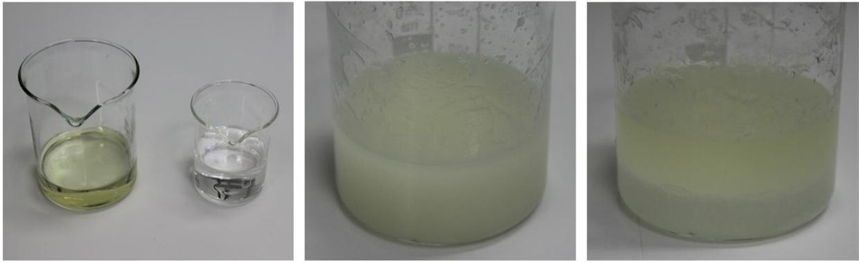
Abbildung 6: Kokosöl-MDGSF-Gemisch und Wasser vor dem Mischen (links) nach einer Minute Mischen (Mitte) und nach einer Minute Standzeit des Gemisches (rechts).
