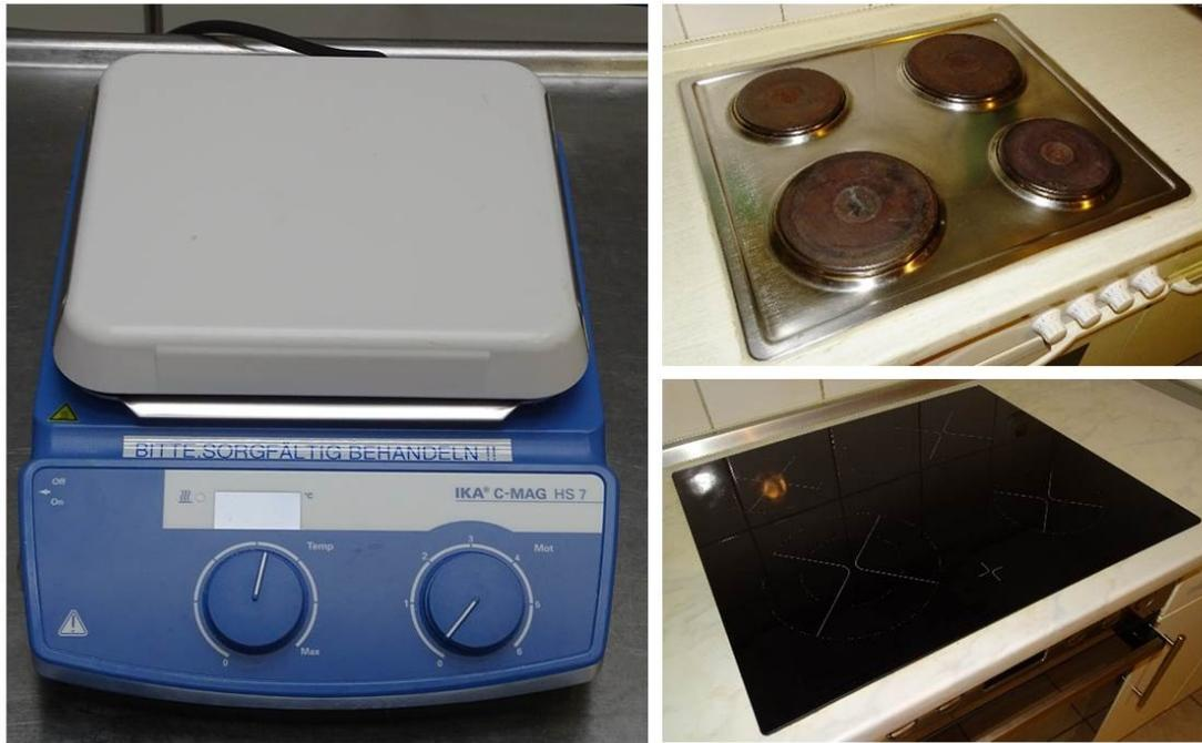
Abbildung 1: Vergleich von Heizplatten aus dem Labor (links) und in der heimischen Küche (rechts, Kochplatte oder Ceranfeld). Fotos aufgenommen vom Institut für Technische Biokatalyse.
