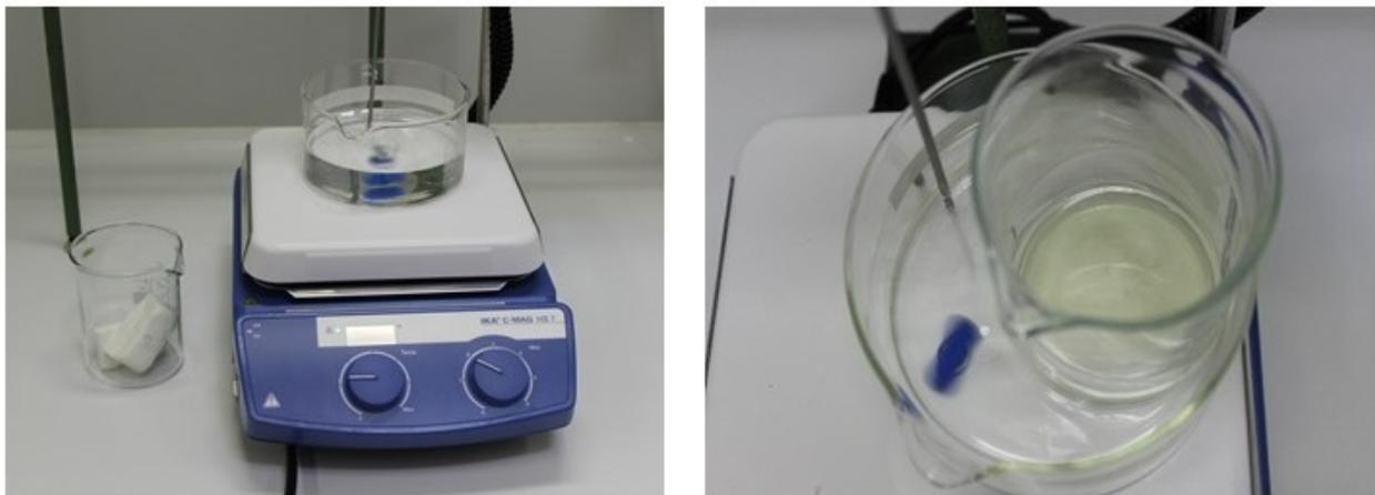
Abbildung 5: Kokosfett bei Raumtemperatur als Feststoff neben dem Wasserbad (links) und bei ca. 50 °C im Wasserbad flüssig (rechts).
