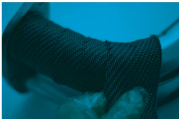
3. Una vez completado el vendaje, se aplican las abrazaderas en ambos extremos del colector de escape. En presencia de curvas acentuadas recomendamos aplicar abrazaderas adicionales.
