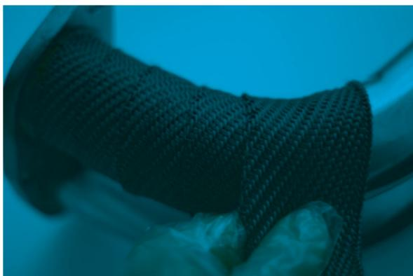
3. Une fois terminé le bandage, appliquer les colliers de serrage aux deux extrémités du collecteur d'échappement. En présence de courbes accentuées, nous recommandons d'appliquer des colliers supplémentaires. Afin d'assurer une meilleure isolation thermique, il est recommandé de doubler le bandage aux l'endroit où seront positionnés les colliers.
