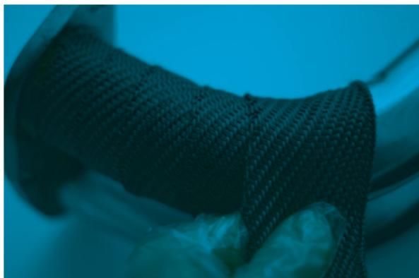
3. Una volta completato il bendaggio, applicare le fascette alle due estremità del collettore di scarico. In presenza di curve accentuate consigliamo di applicare delle fascette supplementari. Per garantire un miglior isolamento termico, consigliamo di raddoppiare la fasciatura nei punti dove verranno applicate le fascette.
