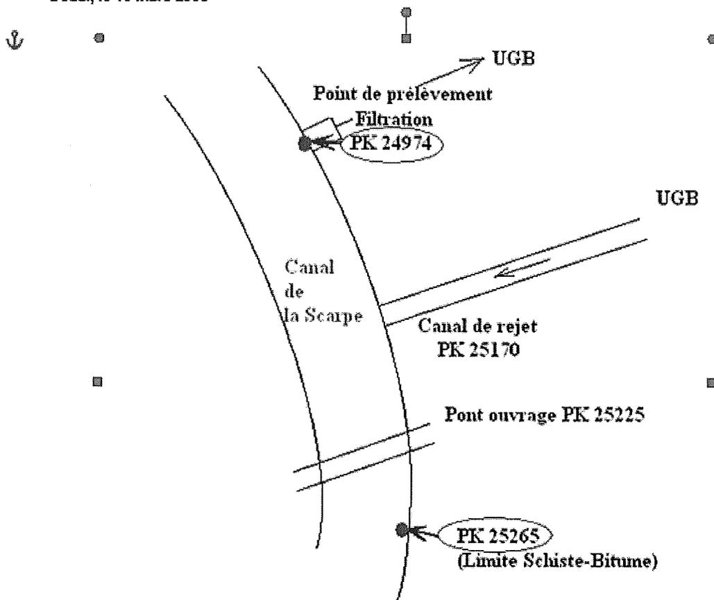
Schéma simplifié du choix des points de prélèvements amont et aval
