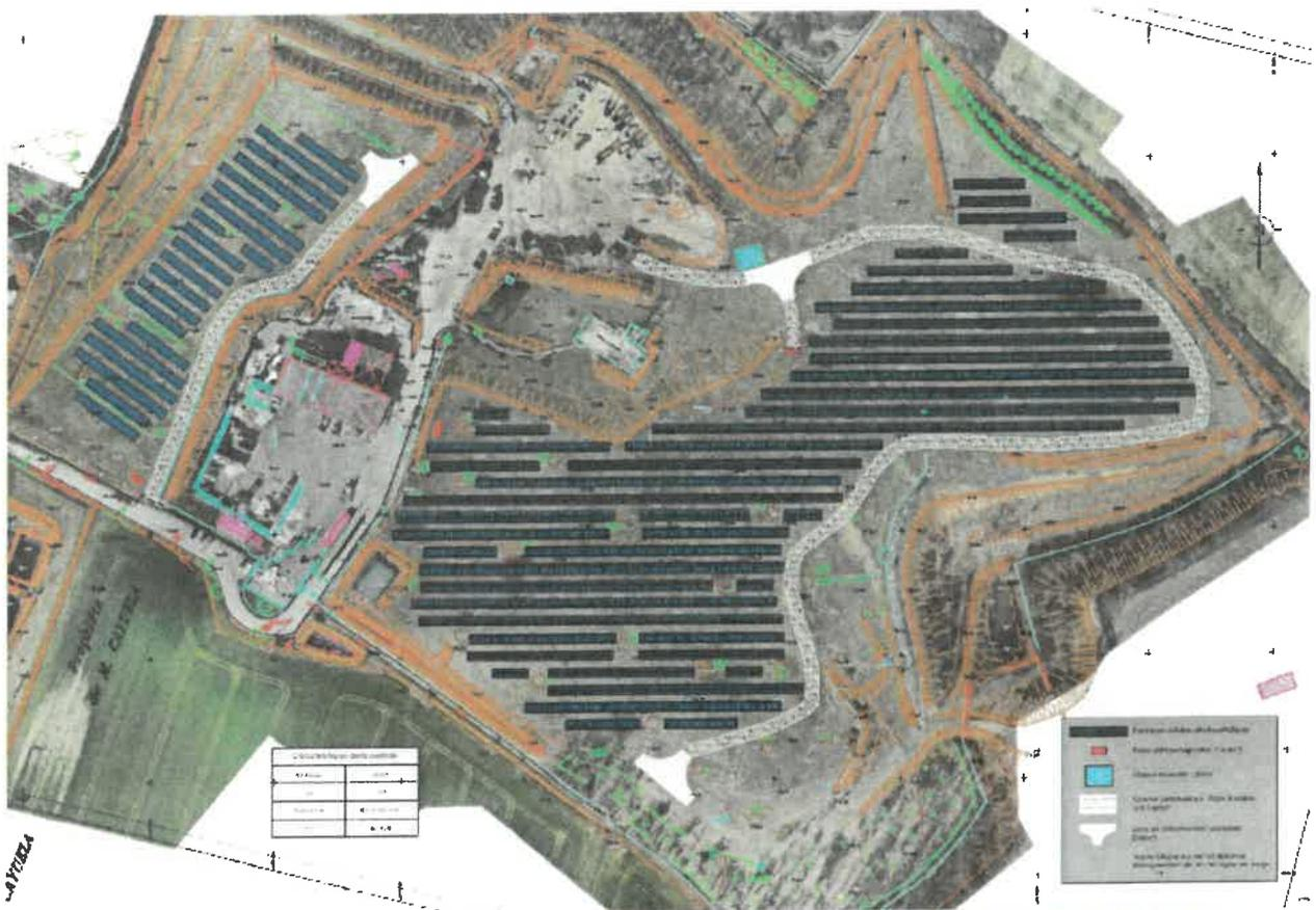
Figure 13 : Plan d'implantation des panneaux photovoltaïques – source : GENERALE DU SOLAIRE
