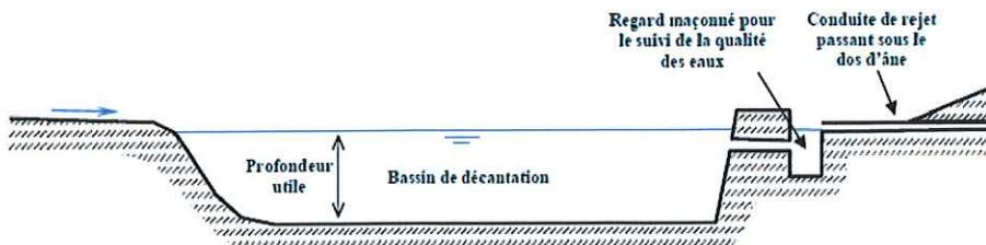
*Schéma de principe du bassin de décantation mis en place avec une évacuation gravitaire des eaux pluviales*
