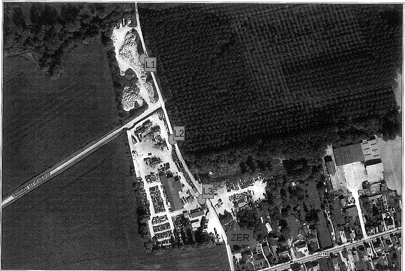
Mesures en limite de propriété et mesures au niveau des zones à émergence réglementée
