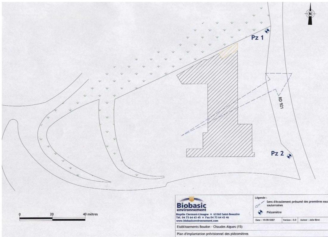
Leur positionnement physique est réalisé selon les recommandations de la norme AFNOR FD X 31-614. Leur repérage physique sera effectué et leur localisation reportée sur un plan d'ensemble. Les piézomètres sont protégés contre les risques de détérioration et munis d'un couvercle coiffant maintenu fermé et cadenassé.
