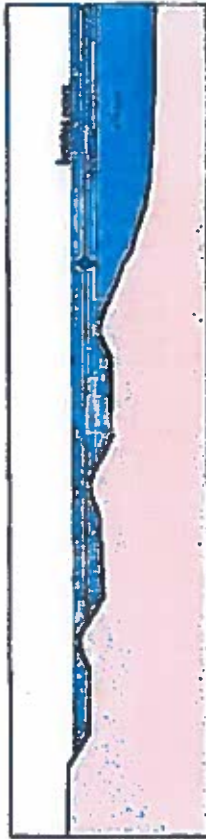
Principe de la berge raide retournée en arrière
