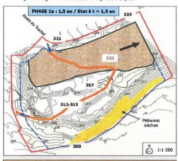
Poursuite de l'extraction au nord de l'emprise - agrandissement de la plateforme de travall jusqu'à la cote de 320 m NGF à l'est de l'emprise, le reste de la plateforme étant déjà à la cote souhaitée.
