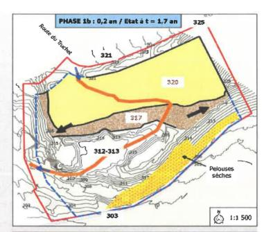
Poursuite de l'extraction au centre de l'emprise - agrandissement de la plateforme jusqu'à la cote de 317 m NGF à l'est et à l'ouest, le reste de la plateforme étant déjà à la cote souhaitée.
