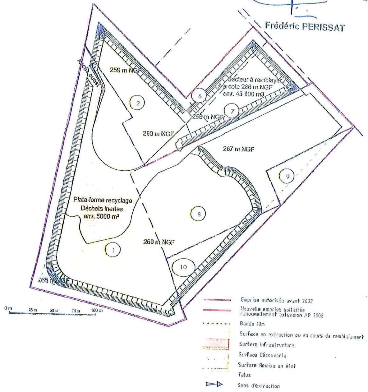
Extraction des parcelles 6 et 7 à une côte TN-8m, gisement restant de 30 000m<sup>3</sup> soit environ 6 ans d'exploitation du gisement avec remblaiement simultané.
