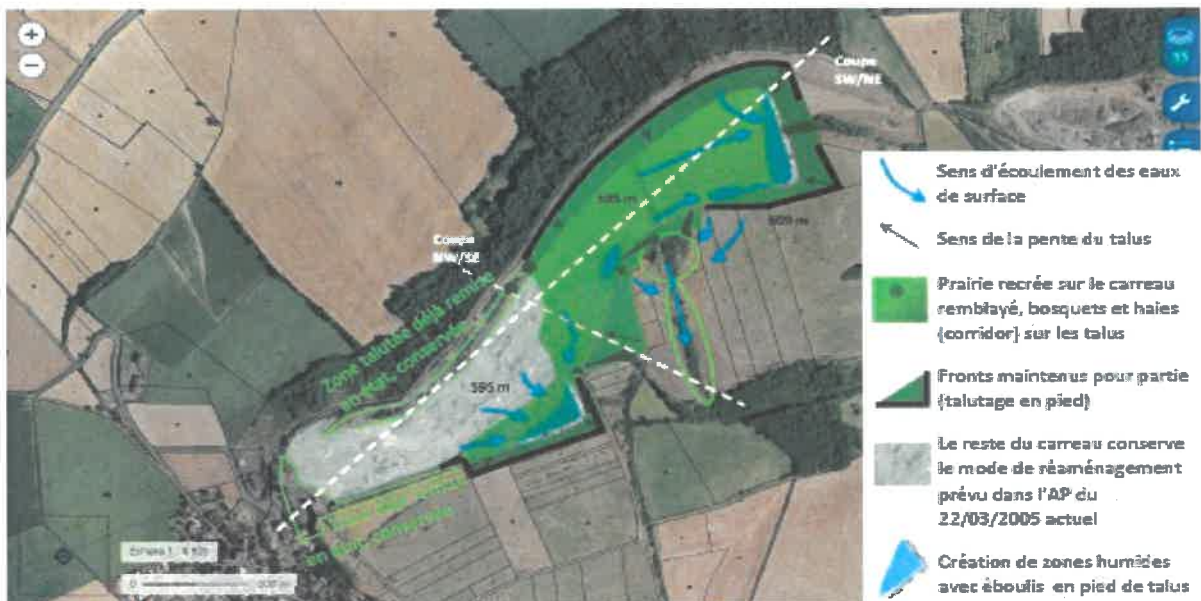
Figure 14 : schéma de principe de réaménagement du site au terme des 15 ans sur la base de 80 000 m 3 /an d'inertes accueillis en remblai
