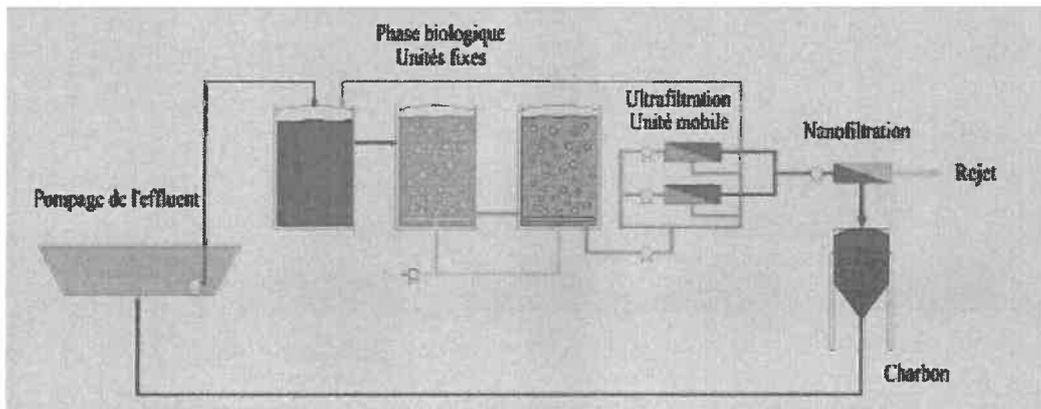
L'installation inclura également un pré-stripping en tête matérialisé par une aération et un chauffage des lagunes de stockage pour améliorer le traitement global. Le process de traitement des lixiviats par BRM pourra évoluer à terme vers d'autres technologies aux performances a minima identiques. Toute évolution fera l'objet d'un porter à connaissance à l'Inspection des installations classées et sera validée avant mise en route opérationnelle.
