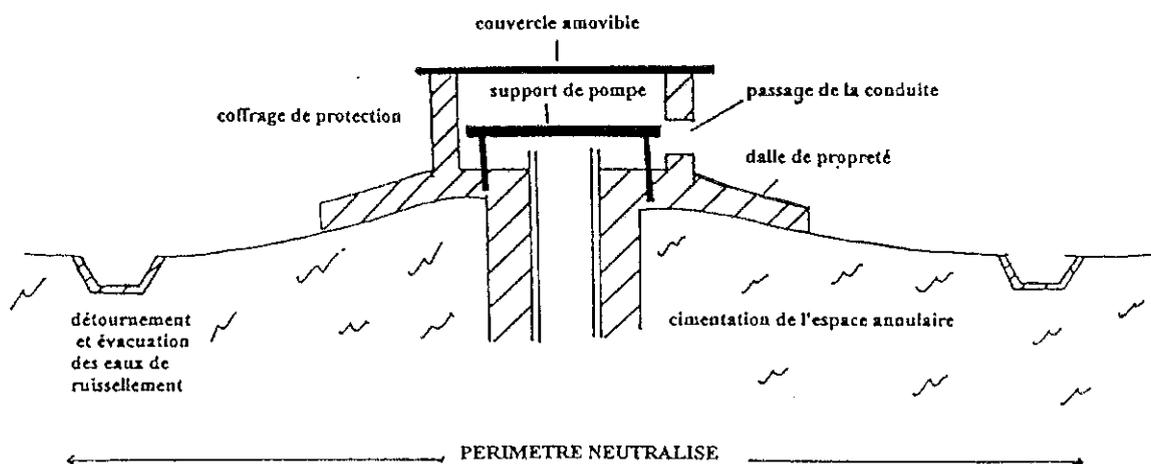
La pompe ne doit pas être fixée sur le tubage mais sur un chevalement spécifique, les tranchées de raccordement ne doivent pas jouer le rôle de drain. La pompe utilisée est munie d'un clapet de pied interdisant tout retour de fluide vers le forage.
