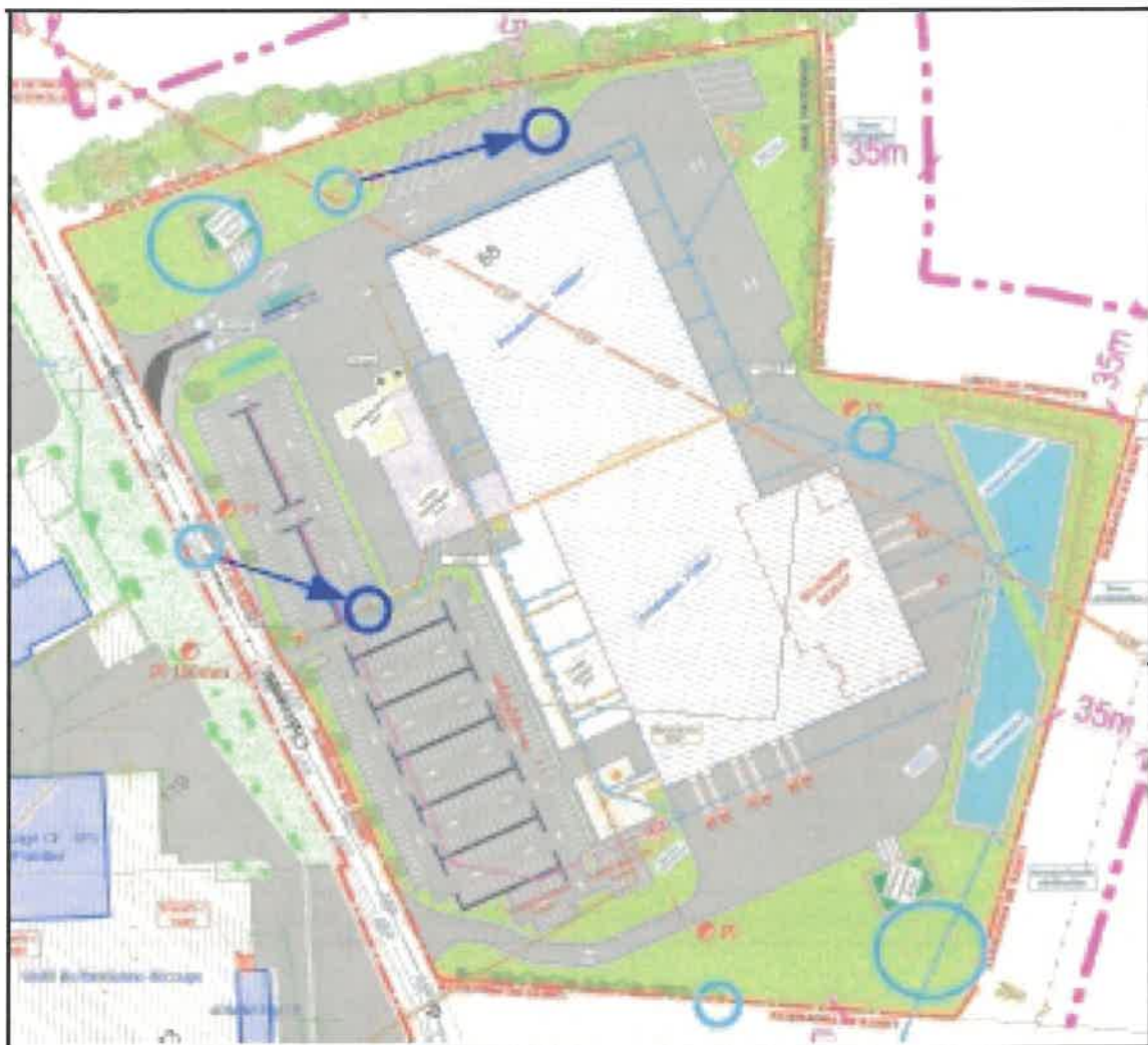
Implantation des points d'eau incendie sur le nouveau site
