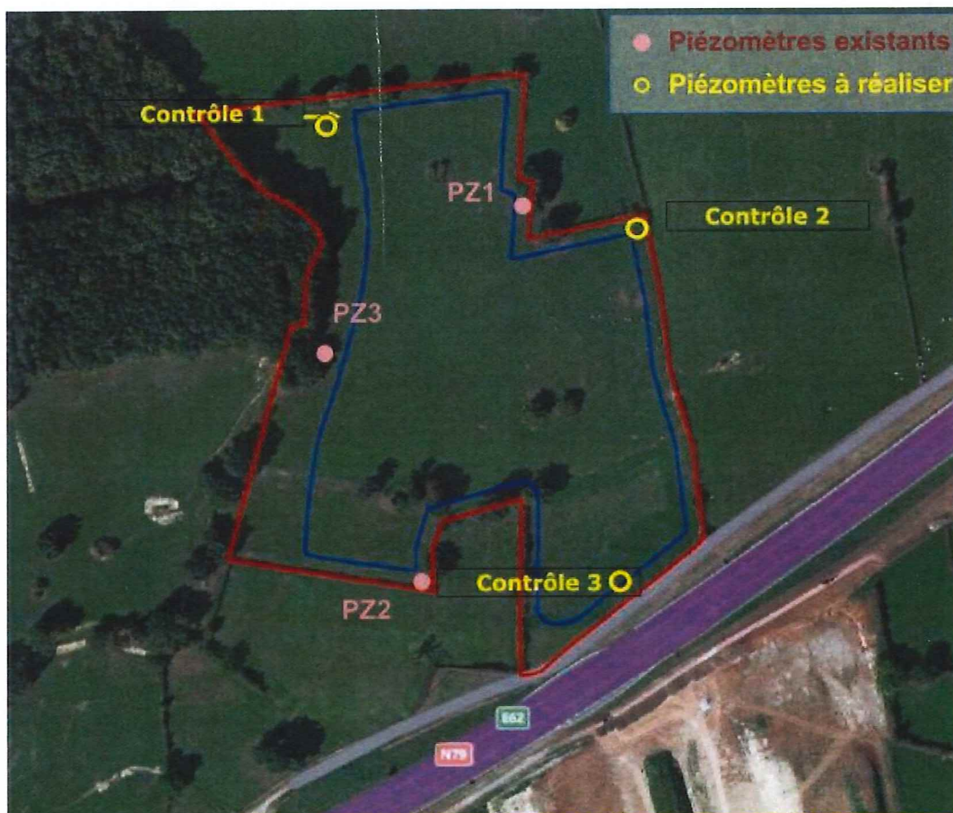
Figure 108 : Proposition d'implantation des piézomètres de surveillance (SAFEGE)
