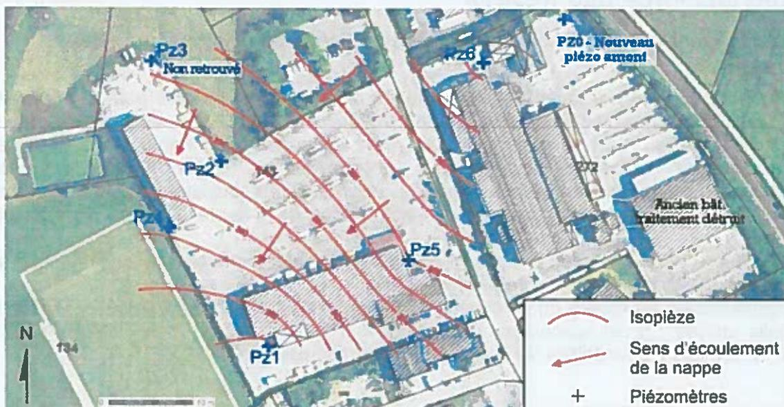
Le piézomètre n°3 ne sera pas remplacé et afin de bénéficier d'un second point en amont, un piézomètre n°7 (indiqué Pz0 sur le plan) est implanté en amont hydraulique du nouveau bâtiment de traitement, côté Est du site.
