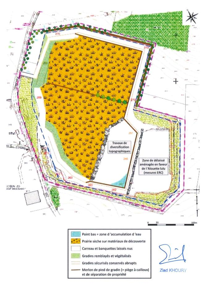
Figure 51 : Principe de la remise en état
