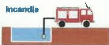
pression sont insuffisants ou absents pour fournir les débits d'extinction (risque courant  $6\text{ l/m}^2/\text{h}$  pendant 2h00, risque particulier  $\geq 60\text{ l/m}^2/\text{h}$  pendant 2h00 ou plus).
