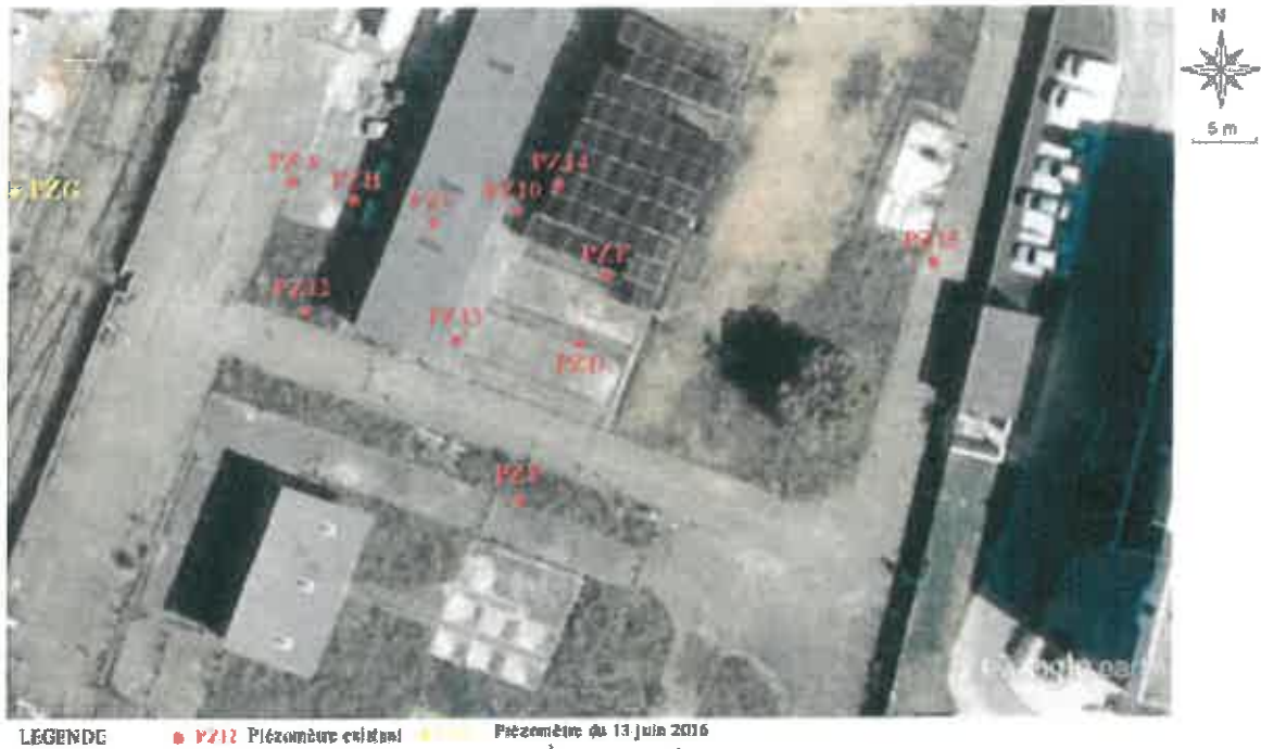
Figure n°1 : Plan d'implantation des piézomètres sur site. (98.24.A.AF(R.47.1).01.1)
